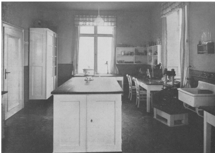
Abb. 3. Laboratorium für die Bestimmung des Trockensubstanzgehaltes der Preßsäfte auf refraktometrischem und gewichtsmäßigem Wege.
